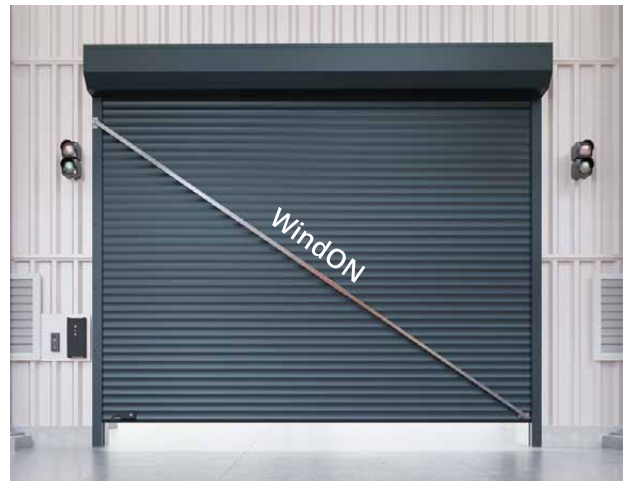
Опір вітру: КЛАС 4 Дослідження проводилося на воротах Intense розміром 400x250 см з використанням системи WindOn і підсилення нижньої планки. Сійкість до проникнення води: КЛАС 2
